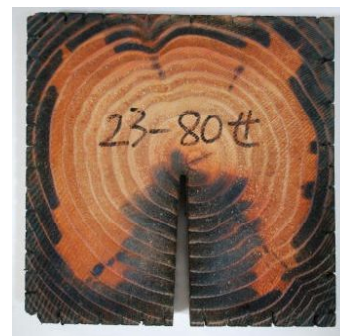
図Ⅲ-2 インサイジング後 加圧注入処理した スギ角材の薬剤浸潤状態
