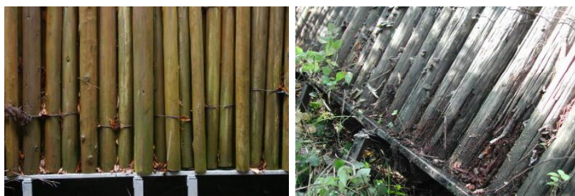
図Ⅲ-3 施工後5年経過した落石防止壁のスギ丸太 左: 加圧注入処理丸太 右: 無処理丸太
