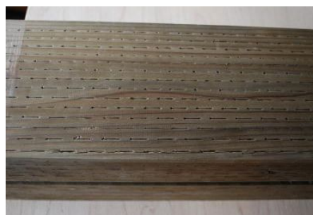
図Ⅲ-4 インサイジング後加圧注入処理したスギ材
