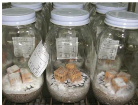
図Ⅱ-5 JIS K 1571に基づく室内試験
