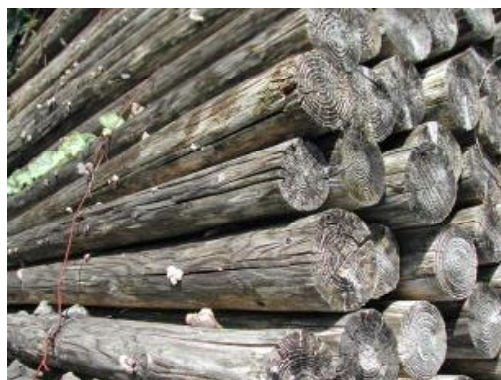
図II-1 スギ丸太の風化 材表面の暗灰色化、木口面の目やせと割れ 生物劣化によるキノコの発生もみられる
