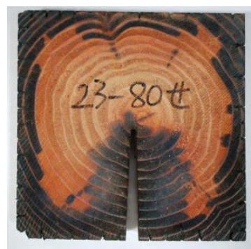
図2-1 呈色液で呈色させた心材のみの角材における保存剤の浸潤状況
