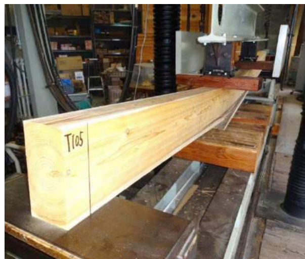
スギ横架材の強度試験
